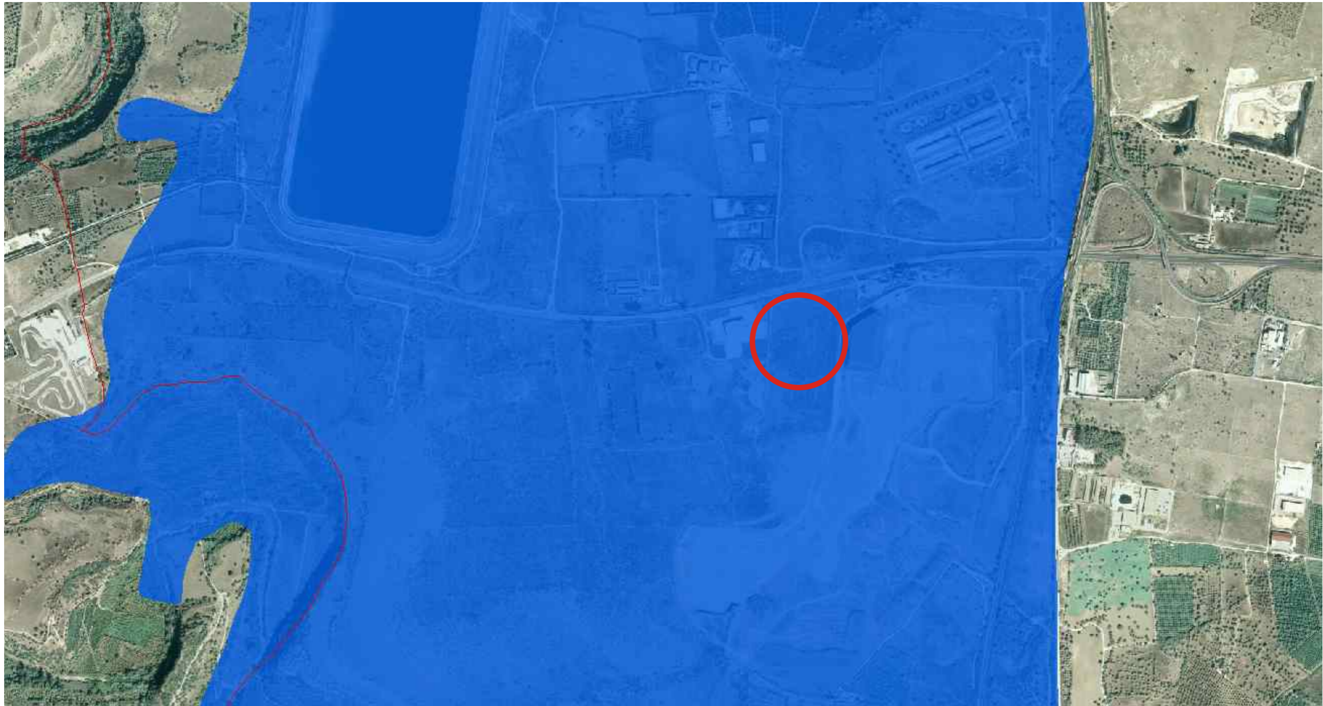
■ Area di esondazione per ipotetico collasso dello sbarramento Ogliastro
